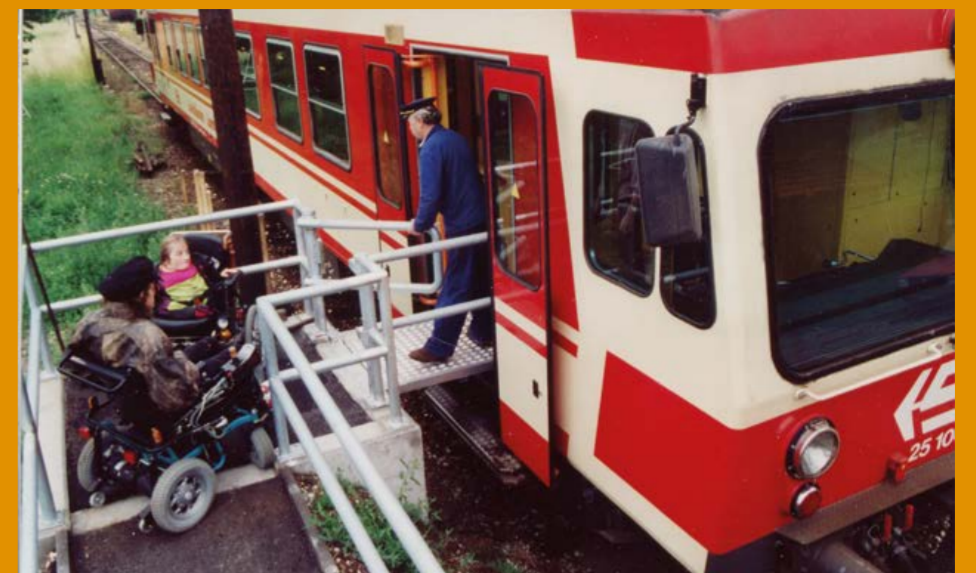
Auch die Mobilität der Bewohnerinnen und Bewohner des Behinderndorfes Altenhof konnte ab 1993 massiv verbessert werden: Eine Rampe mit spezieller Überfahrbrücke ermöglichte ein barrierefreies Einrollen selbst schwerster Elektro-Rollstühle. Nun wurden Ausflüge per Haager Lies nach Wels sehr populär. Diese Initiative wurde mit dem VCÖ-Mobilitätspreis ausgezeichnet.
