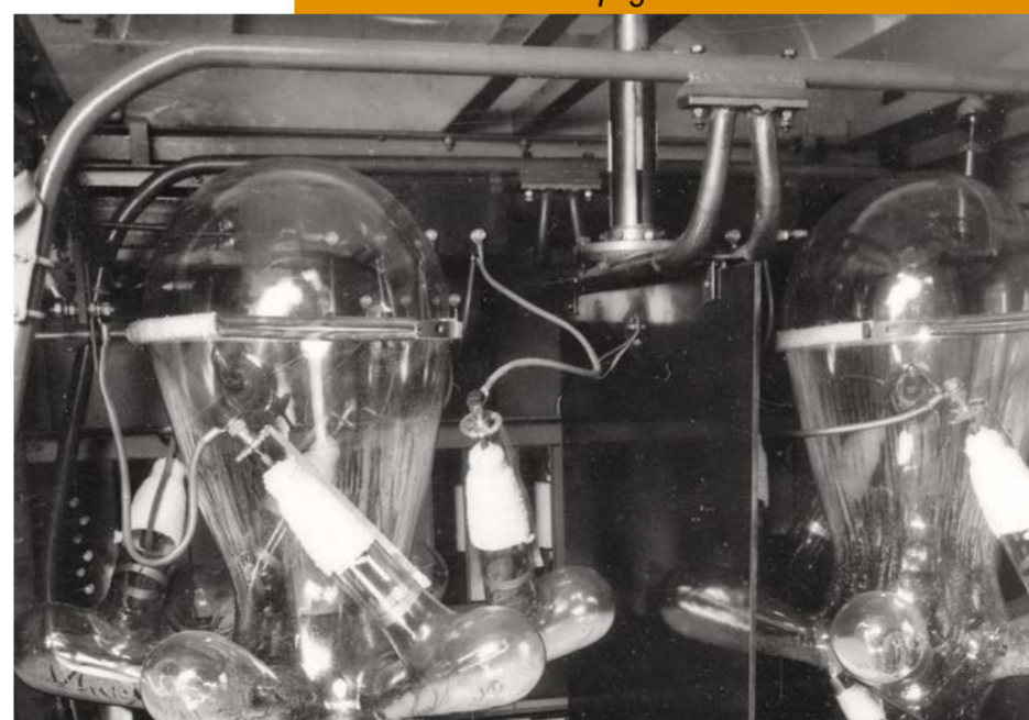
Quecksilberdampfgleichrichter im EGL 25 052.
